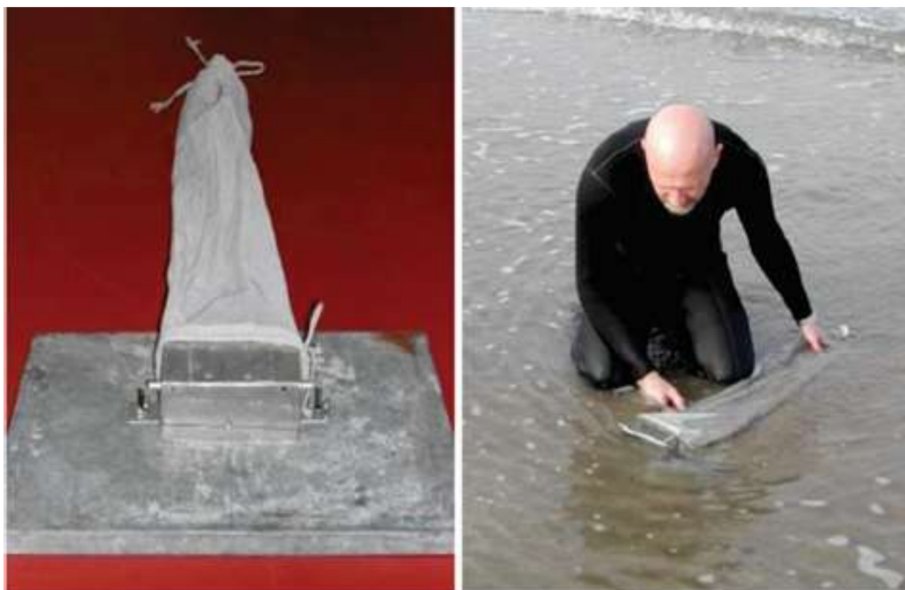
Figura 8 – Método de obtenção de dados por armadilha de sedimentos para o espraçamento, obtenção de material in situ. Armadilha construída em alumínio, chapa metálica, tecido de poliéster e barbantes. Figura e modelo adaptados de Fontoura (2004).
