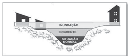
Figura 2 - Perfil esquemático dos processos de enchente e inundação. Fonte: Brasil (2007).
