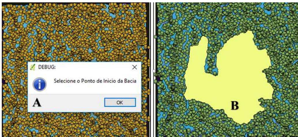
Figura 5 - (A) Indicação de ponto para o delineamento da bacia hidrográfica (B) BHC delineada pelo algoritmo ODR\_Obia
