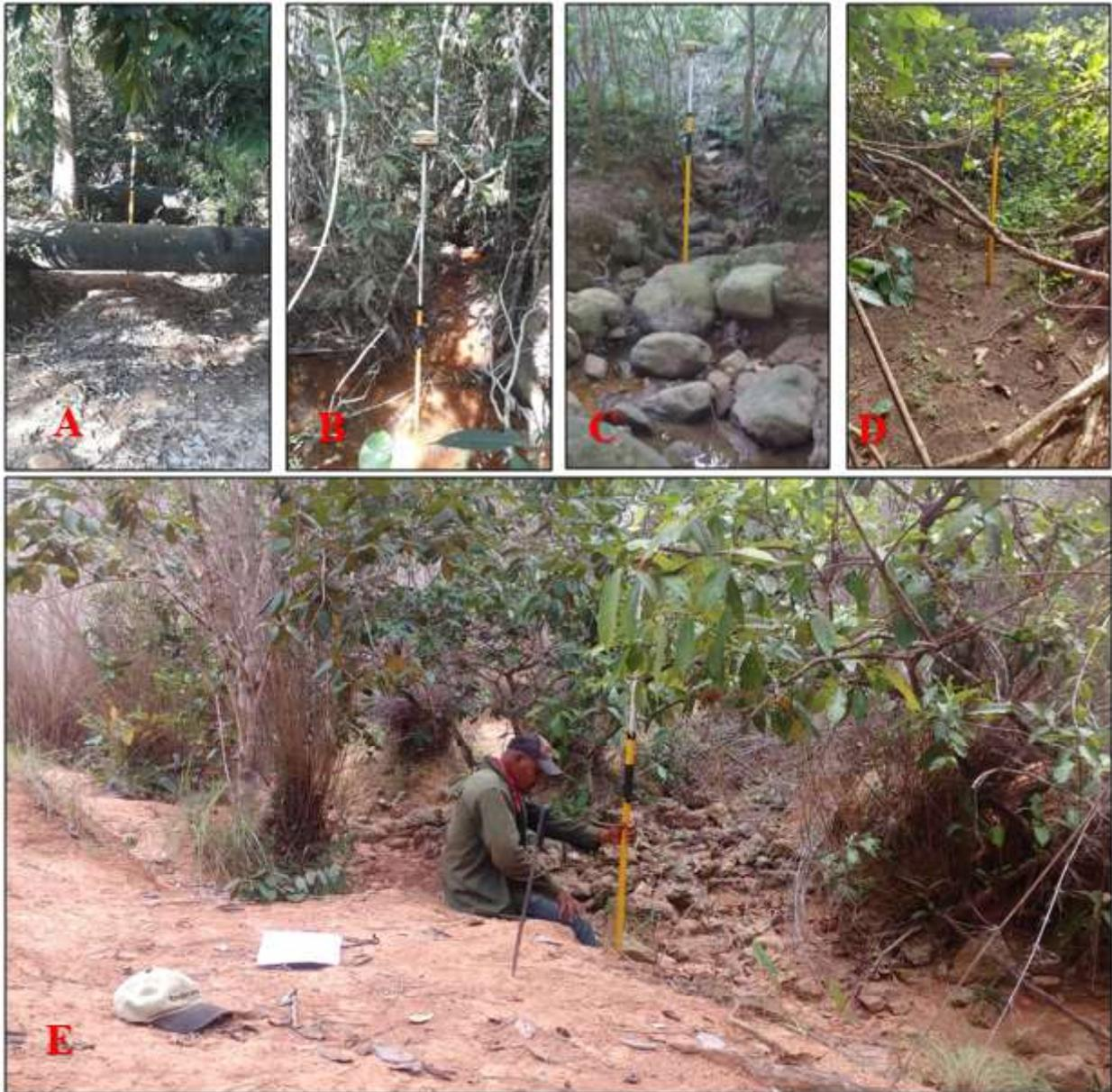
Figura 13 – Coleta de pontos nas bifurcações para validação do modelo ODR\_Hidro.
