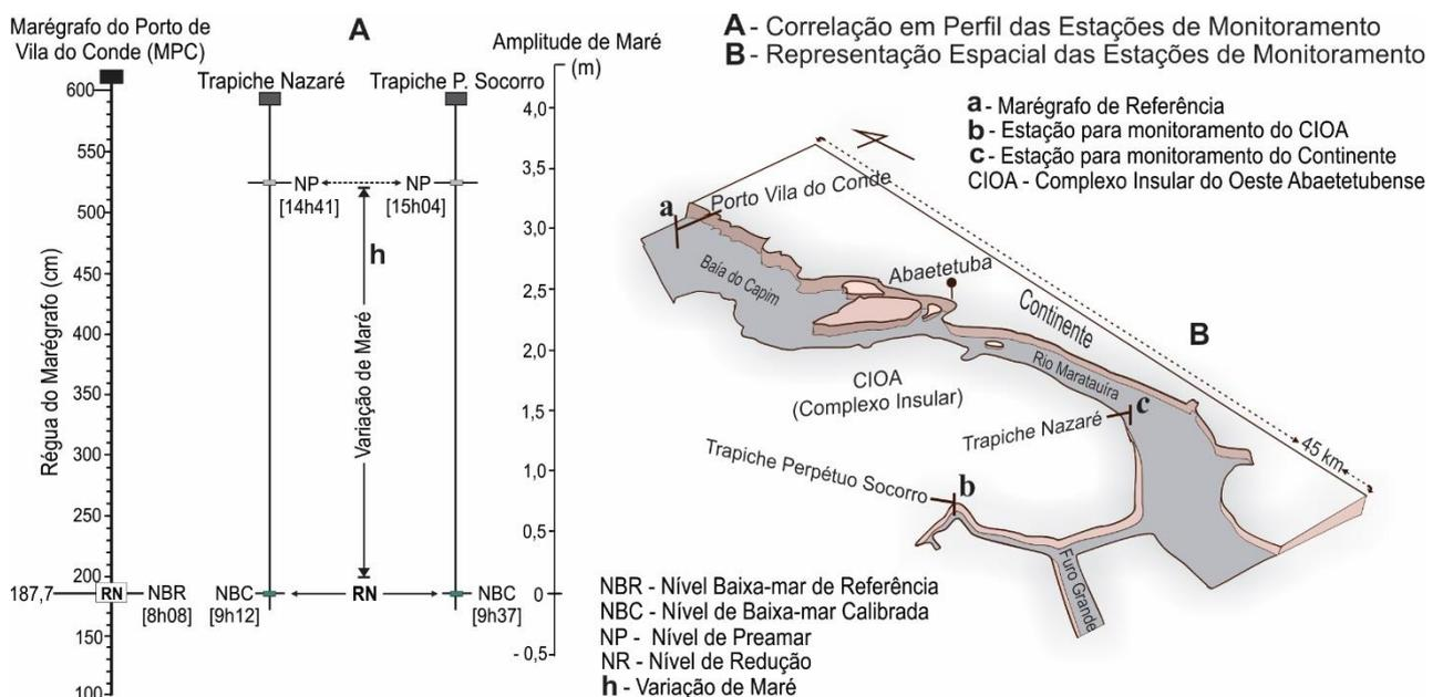
**Figura 2.** Esboço integrado das estações P. Socorro e Nazaré, as quais foram calibradas em relação ao Marégrafo do Porto de Vila do Conde (A), incluindo a situação geográfica das estações (B).
