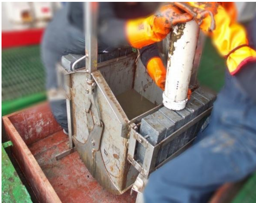
Figura 3. Amostragem de sedimentos com Box Corer em canos de PVC durante a Operantar XXVI (janeiro, 2018. Arquivo pessoal).
