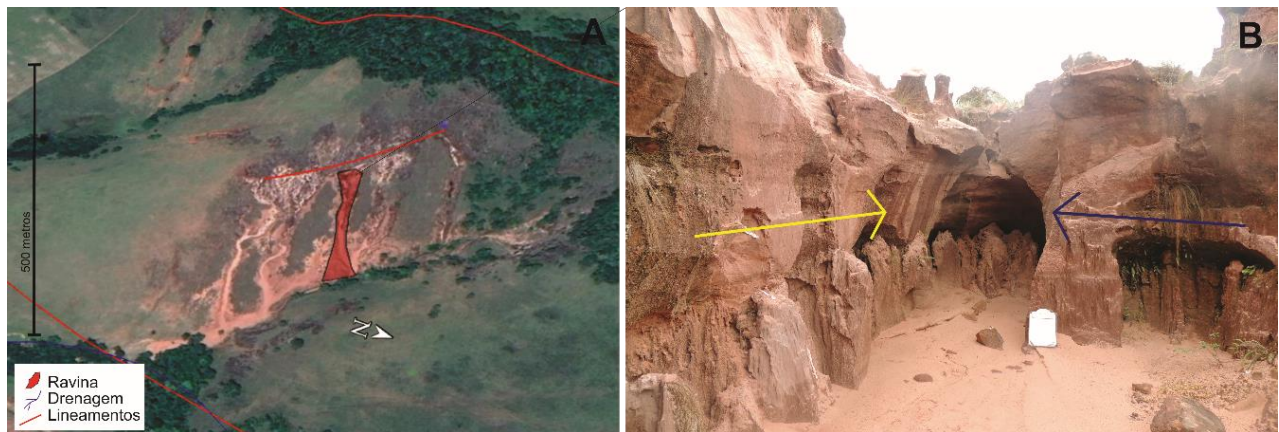
Figura 20. Vista geral da Ravina 4 e de seu entorno, como delimitação das drenagens, dos lineamentos e do leito do processo erosivo (A). Em (B), detalhe da cabeceira do leito percorrido a campo (delimitado em vermelho, à esquerda), que segue duas direções principais: uma, a N50°O (desenvolvimento remontante, seta azul) e outra, a N31°E (desenvolvimento lateral, seta amarela). Nota-se a presença de pipings , na confluência dos dois lineamentos, identificados na cabeceira da ravina. Bacia Hidrográfica do Arroio Miracatu, RS. Fontes: Google Earth® e acervo pessoal dos autores (janeiro de 2017).
