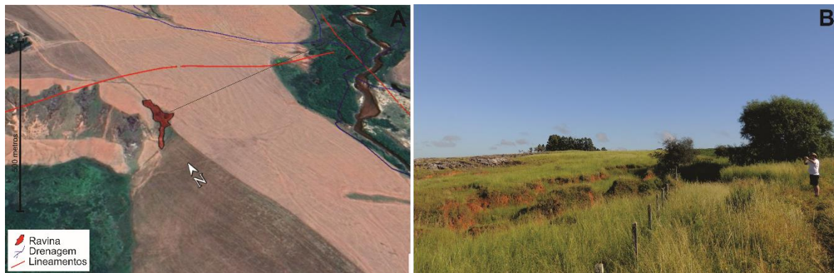
Figura 21. Vista geral da Ravina 5 e de seu entorno, como delimitação das drenagens, dos lineamentos e do leito do processo erosivo (A). Em (B), vista lateral esquerda, em campo, dos eixos de desenvolvimento da Ravina 5. Bacia Hidrográfica do Arroio Miracatu, RS. Fontes: Google Earth® e acervo pessoal dos autores (janeiro de 2018).
