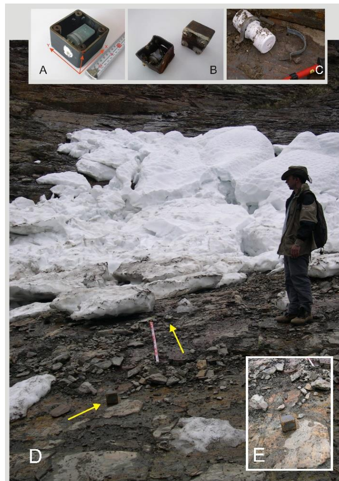
Figura 5. A: Na experiência, foram utilizados registradores automáticos de aceleração "Onset Pendant G" (gama de medição: \pm 3 g; resolução: \pm 0,025 g; precisão: \pm 0,075 g), equipados com um acelerômetro triaxial que permite determinar a inclinação do registador ou da caixa metálica na qual foi fixado. Os registadores estão alojados dentro de caixas de proteção com 80 x 80 x 55 mm. Cada eixo do elemento sensor é paralelo a uma das três dimensões da caixa. B: A pressão subnival pode destruir as caixas metálicas que protegem os registadores. Na imagem, uma caixa pegou no chão ao lado de outra, quebrada pelo efeito da ação subnival. C: Os registadores de temperatura "UTL-1" © protegidos por uma caixa de PVC, as fixações metálicas foram removidas pela ação subnival. D: Vista das caixas metálicas no sítio experimental. E: Vista de perto. Fonte: Os Autores.
