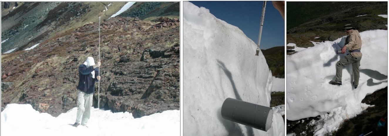
Figura 6. Medição das características de espessura e densidade da neve. Fonte: Os autores.
