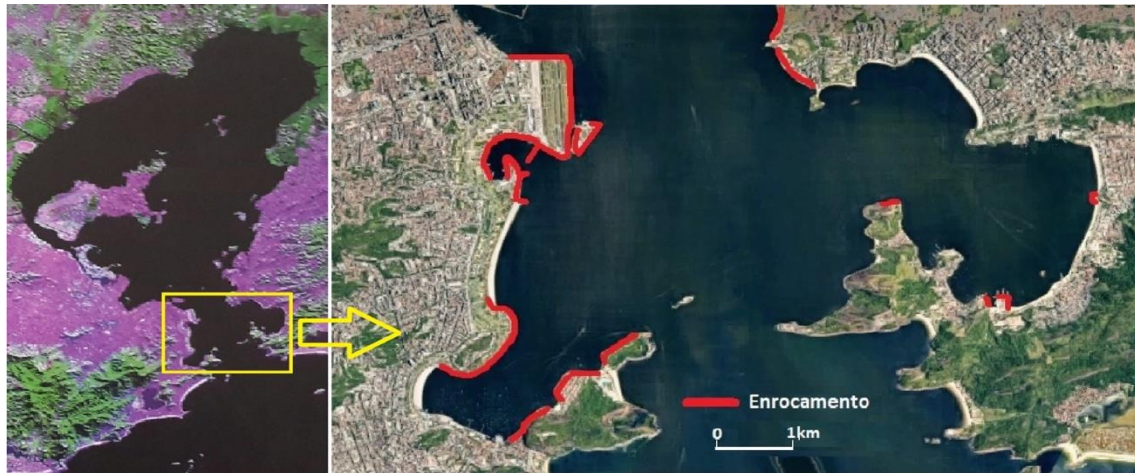
Figura 16. Na área representada nesta imagem da Baía de Guanabara, que é uma parte da área de estudo, foram construídos aproximadamente 15 km de enrocamento, que equivale a 57% do total construído no Rio de Janeiro, Niterói e São Gonçalo. Este dado refere-se apenas às estruturas visíveis que estão na superfície. Imagens: Landsat e Google Earth.
