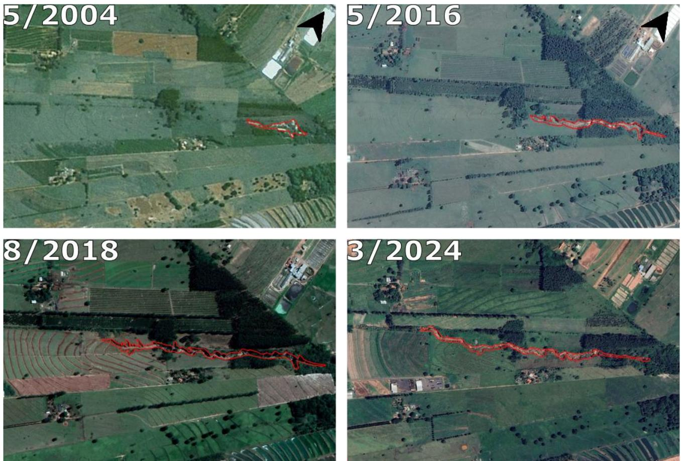
**Figura 8.** Evolução de Voçoroca no distrito de Sumaré, Paranavaí (latitude: 23° 4'35.79"S; Longitude: 52°23'37.74"O). Em vermelho perímetro da voçoroca ao longo dos anos. Fonte: Google Earth pro
