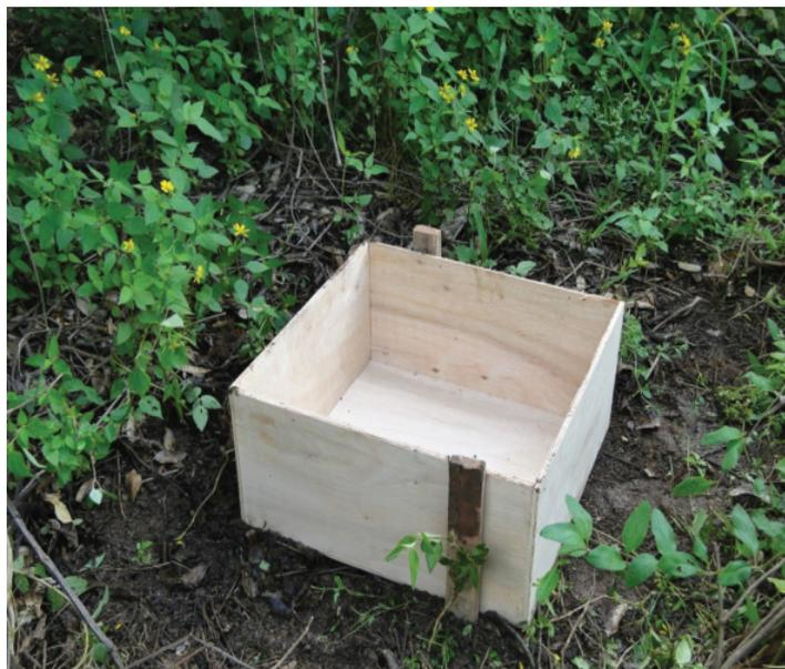
Figura 2 – Caixa coletora de sedimentos instalada na planície de inundação.
